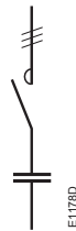
Esquema de banco de capacitores de etapa única Use as gamas de contatores AF..., AFC... ou UAFC...
